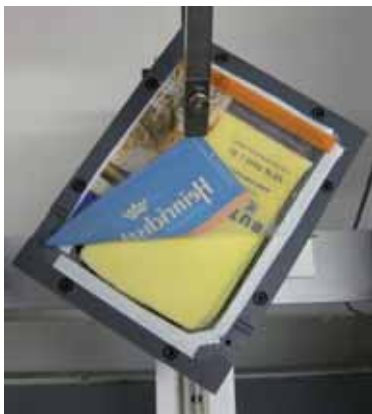
Abbildung 3: Prüfung der Öffnungskräfte an einer wiederverschließbaren Verpackung bei einem Aufreißwinkel von 135°
